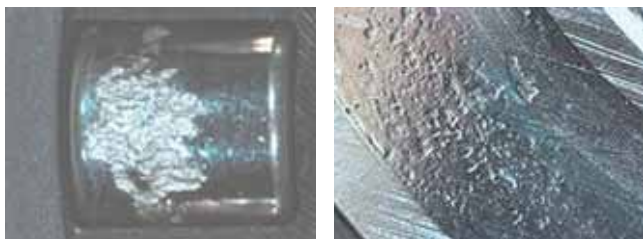
POE ISO VG 170 bez aditiv - pitting, opotřebení
